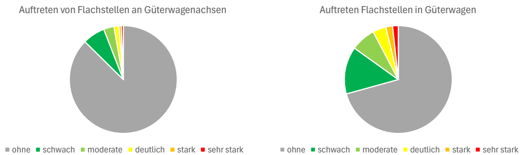
Abbildung 22 Links: Anteil Güterwagenachsen mit mindestens einem Rad in der jeweiligen Klasse für Flachstellen-Indikation. Rechts Anteil Güterwagen mit mindestens einem Rad in der jeweiligen Klasse für Flachstellen-Indikation
